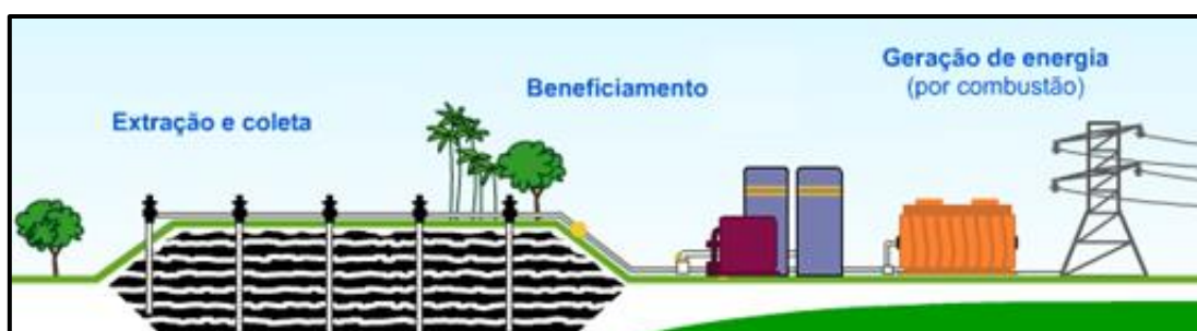
Figura 21: Processo de geração de energia elétrica através do biogás.
